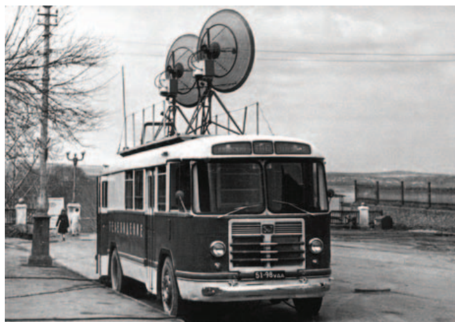
Сейчас это кажется парадоксальным, но до появления видеомagneтофонов практически все репортажи снимались в прямом эфире с помощью передвижных телевизионных станций (ПТС). На фотографии одна из таких ПТС, сделанная на базе автобуса «ЗИЛ».
